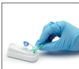
3. 將檢體管的所有內容物倒入 SNAP 貓 proBNP 裝置的檢體孔中。
