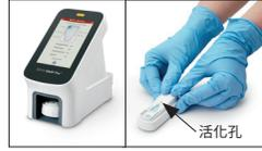
4. 使用 SNAP Pro<sup>†</sup> 分析儀，自動啟動 SNAP 檢測及解讀結果。
