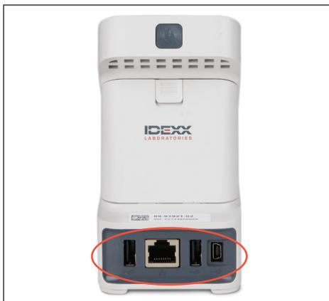
1. 關閉分析儀的電源並拔除電源和/或乙太網路連接埠的連線。
