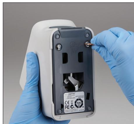
7. 將銀色扣件以順時針方向轉動四分之一圈以將基座鎖至定位。
