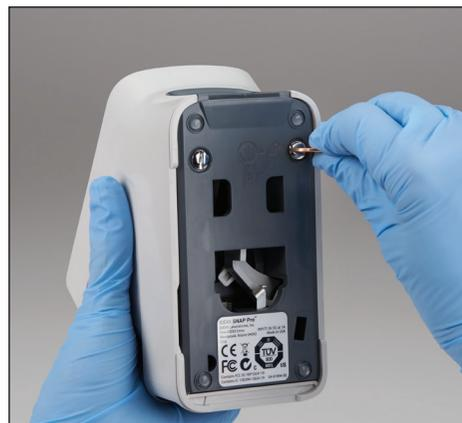
2. 在已關閉電源的分析儀的底部，使用平頭螺絲起子或硬幣將 2 顆銀色扣件以逆時針方向轉動四分之一圈。
