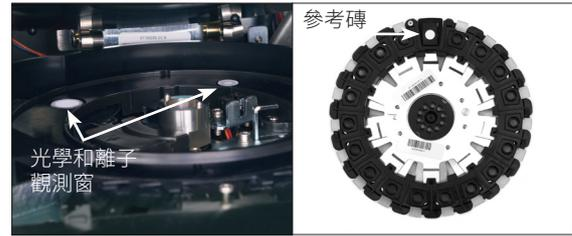
8. 使用 IDEXX 適用的乾拭鏡紙擦乾光學觀測窗、離子觀測窗和白色參考磚，確認清潔後的元件上沒有尚未揮發掉的濕氣。如果殘留痕跡或髒污，請重複清潔程序。
