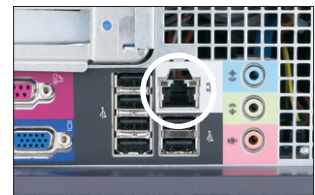
IDEXX VetLab Station计算机CPU背板上的以太网端口
